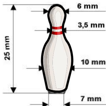
Les quilles ont une hauteur de 25 mm. Leur diamètre est de 6 mm à la tête, de 10 mm à l'endroit le plus large et de 7 mm à la base. Elles sont toutes de forme et de dimensions identiques.
